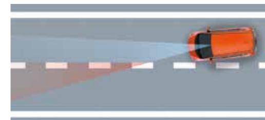
Quando o sistema deteta as marcações da estrada e caso o veículo se desvie da faixa de rodagem atual sem sinalizar a manobra, o Sistema Avisador de Saída da Faixa de Rodagem alerta o condutor de forma visual e acústica.
