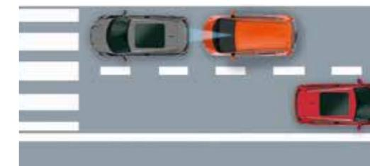
3: Caso o condutor continue a não reagir e a colisão seja iminente, o Sistema de Travagem Ativa em Cidade aplica travagem para reduzir o mais possível a velocidade. Em boas condições de condução, esta ação pode conseguir evitar completamente a colisão.
